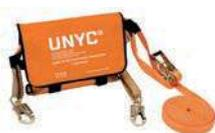
Permet de sécuriser le déplacement horizontal sur une longueur de 20 m. Sangle polyester 35 mm avec 2 anneaux d'ancrage de 1 m et connecteurs alu rotatifs. Ouverture Ø 19 mm. Équipée d'un élément d'attache à cliquet à double verrou de sécurité et contrôle de la tension régulière. Sac PVC inclus.
